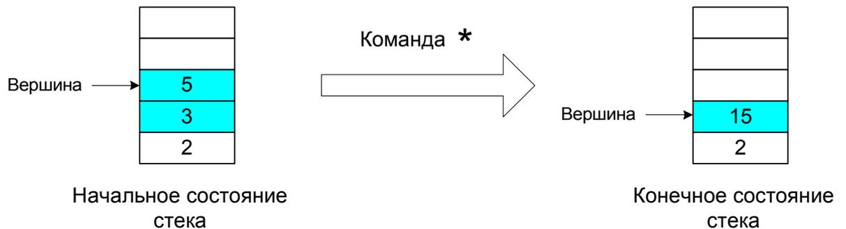
Рис. 11. Схема работы команды «\*» в стековой машине
