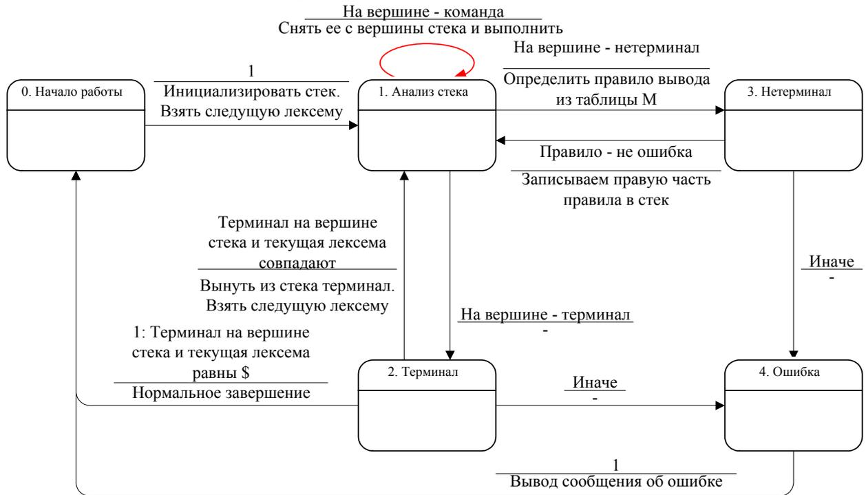
**Рис. 10.** Граф переходов преобразованного автомата синтаксического анализатора
