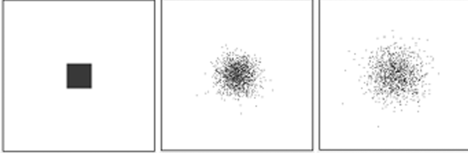
Рис. 4. Наивная асинхронная КА-диффузия: глобальные состояния клеточного массива при t=0 , t=100 , t=250
