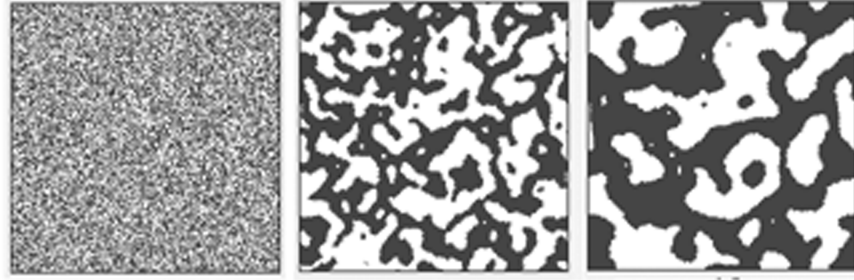
Рис. 2. Эволюция КА, моделирующего процесс разделения фаз. Глобальные состояния при t = 0, t = 5, t = 10
